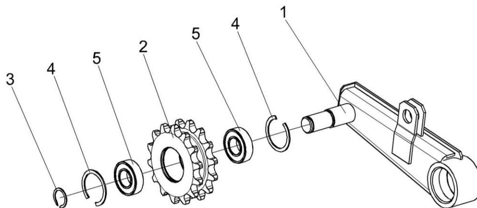
Рисунок 9 – Устройство натяжное КЗК-10-0505120
